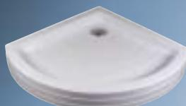
Vaničky typu PU se skládají z koextrudované skořepiny a polyuretanového nosiče zpevněného skelnou rohoží. PU vanička je samonosná, lisovaná vcelku s panelem.
